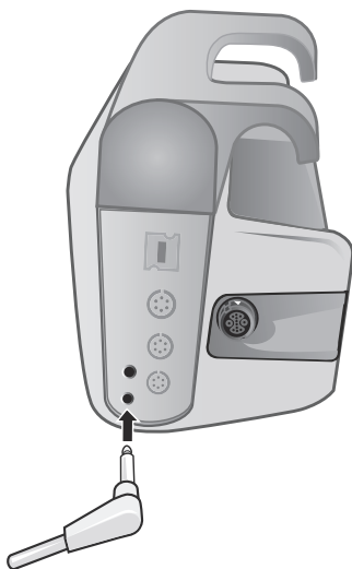
Figura 12-1 Collegamento della sonda della temperatura all'unità X Series
