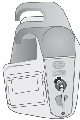
Figura 8-2 Collegamento di un tubo a lume singolo all'unità X Series
