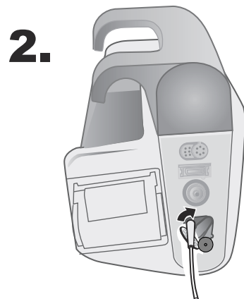
Figura 9-1 Collegare il connettore della linea di campionamento alla porta di ingresso della CO 2 .
