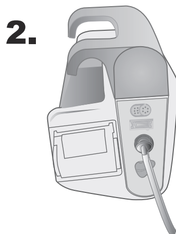
Figura 8-1 Collegamento di un tubo a doppio lume all'unità X Series
